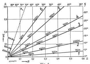
Fig. 3 Impédance et angle  $\xi$  des amenées de courant  $\omega L$  Réactance effective, R Résistance effective 1 Câble à trois conducteurs, 25 mm² Cu, 2 Câble à trois conducteurs, 70 mm² Cu, 3 Câble à trois conducteurs, 150 mm² Cu, 4 Ligne aérienne, écartement des pôles 50 cm, 6 mm  $\phi$  Cu, 5 Ligne aérienne, écartement des pôles 50 cm, 8 mm  $\phi$  Cu, 6 Ligne aérienne, écartement des pôles 50 cm, 10 mm  $\phi$  Cu, 7 Transformateurs.
