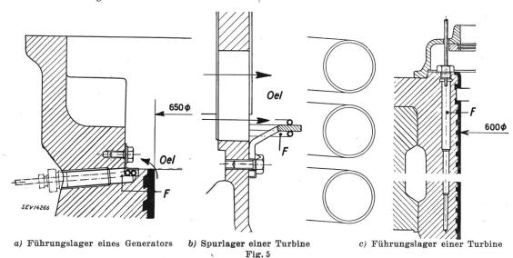
Beispiele für den Einbau des Temperaturfühlers F in Führung und Spurlager
