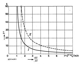
Fig. 3 Ansprechzeit t' in Funktion der Temperaturanstieggeschwindigkeit  $\frac{\mathrm{d}\vartheta}{\mathrm{d}\,t}$
