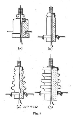
Für die Ueberschlagprüfung verwendete Typen von Durchführungsisolatoren
