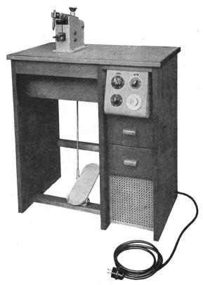
$\begin{array}{c} \textbf{Fig. 1} \\ \textbf{Tischpunktschweissmaschine Typ Tpz 4} \\ \textbf{mit Zeitsteuerung für Eisenblech } 1+1 \ \textbf{mm} \end{array}$
