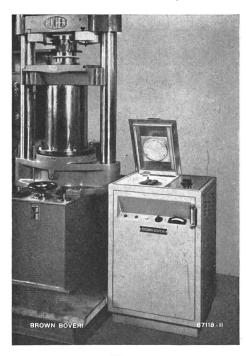
Fig. 2 Hochfrequenz-Röhrengenerator
