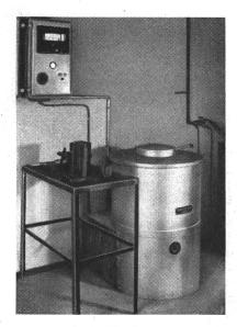
Fig. 2 Elektrischer Goldschmelzofen Höchsttemperatur 1250°C
