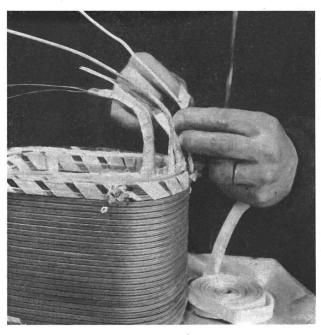
Fig. 1 Glasisolierte Wicklung eines serienmässig hergestellten Schweisstransformators
