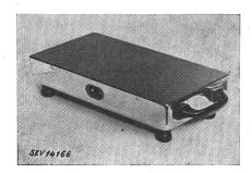
Chauffe-plats, selon figure. La résistance de chauffe, noyée dans une masse isolante à base de terre réfractaire, est placée dans un bâti en tôle chromée de  $75 \times 165 \times 305$  mm. Les pieds sont en bois et les poignées en matière isolante moulée. La fiche d'appareil est encastrée. L'appareil n° 2 est muni d'un régulateur de température.
