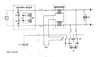
Fig. 6 Schalt- und Anschlußschema des Gebührenmelders
