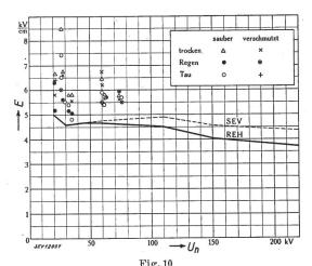
Fig. 10 Gradients de potentiel (E) en fonction de la tension nominale  $(U_n)$ , le long d'isolateurs pour postes extérieurs (d'une armature à l'autre), au moment où est atteinte entre les cornes des éclateurs de sécurité la tension 50 % de contournement au choc normal positif  $(1|50 \mu s)$
