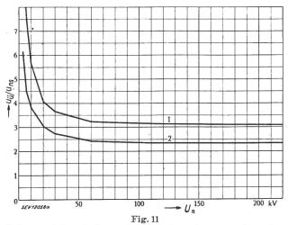
Valeurs minima de la tension 50 % de contournement au choc du matériel à haute tension (1) et valeurs maxima de la tension résiduelle et de la tension 50 % d'amorçage des parafoudres et éclateurs de protection (2) conformément au projet des Règles pour la coordination, par rapport à la valeur de crête de la tension nominale composée (Ua / Uns)
