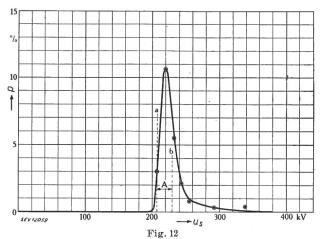
Pour centage des amorçages intempestifs p entre les pôles d'un disjoncteur pneumatique ultra-rapide sollicité par des chocs de tension positifs 1|50  $\mu$ s de différentes valeurs de crête, en fonction de la tension appliquée  $U_s$
