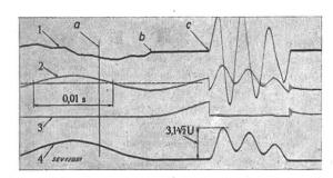
Oscillogramme ordinaire, relevé lors du déclenchement d'une capacité par un disjoncteur à bain d'huile
