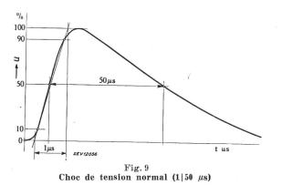
avec lequel sont exécutés la plupart des essais, présente une durée de front de  $1~\mu s$  et une durée de mi-amplitude de  $50~\mu s$  (temps durant lequel la valeur momentanée est égale ou supérieure à la moitié de la valeur de crête). Les tensions de choc, comme précisément les surtensions d'origine atmosphérique en général, sont donc des phénomènes de très brève durée, de l'ordre de quelques microsecondes, c'està-dire de quelques millionièmes de seconde.
