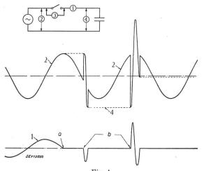
Fig. 4 Déclenchement d'une capacité
