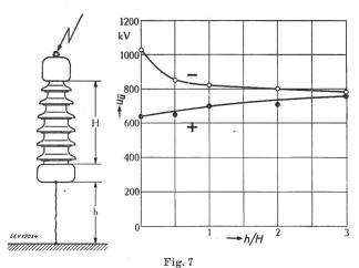
Tension 50 % de contournement au choc d'un isolateur-support en cas de choc normal 1|50 \mus, en fonction de la distance par rapport à la terre
