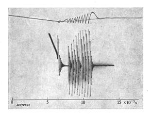
Fig. 3 Oscillogramme cathodique, relevé lors du déclenchement d'un transformateur à vide
