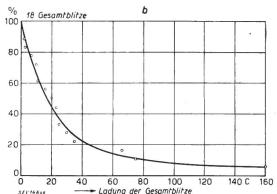
Fig. 16 Elektrische Ladungen in den Blitzen a in Teilblitzen b in Gesamtblitzen
