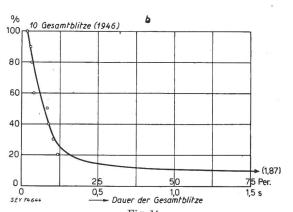
Fig. 14 **Häufigkeit verschiedener Dauer des Gesamtblitzes**a Aus 22 Oszillogrammen (1943...1946)
