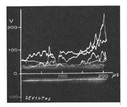
Fig. 22 Originaloszillogramme von Blitzentladungen, mit Rahmenantenne aufgenommen
