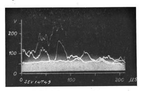
Fig. 29 Originaloszillogramme eines Blitzes, der einen Menschen und ein Pferd auf offenem Felde tötete und einen Heu-wagen in Brand setzte
