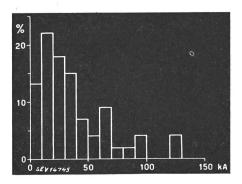
Fig. 25 Prozentuale Verteilung der maximalen Stromstärken bei 46 Hauptentladungen
