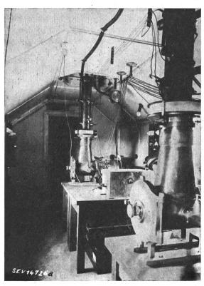
Fig. 5 Kathodenstrahl-Oszillographen mit Hilfsgeräten in beweglicher Feldstation
