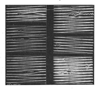
Fig 10 Oszillogramme von entfernten Blitzentladungen
