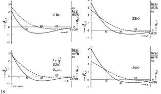
Der Wärmefluss klingt mit zunehmender Entfernung von der Oberfläche im selben Verhältnis ab, wie die Temperaturschwingung; es ist:
