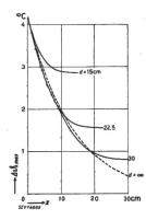
chen. In Fig. 24 ist für dieses Beispiel der Verlauf der Amplituden in Abhängigkeit vom Abstand von den Aussenflächen für die drei genannten Mauern dargestellt, und, wiederum zum Vergleich, mit punktierter Linie der Amplitudenverlauf im Fall der nur einseitig eben begrenzten Materie.
