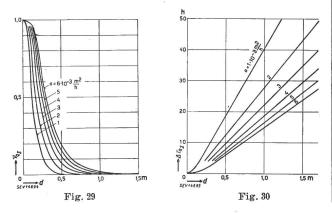
Die Amplitude der Wärmeflußschwingung an der Innenfläche der Mauer ist für grosse Werte von  $\Sigma$
