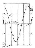
den Wärmefluss  $q_{Wt}$  am gleichen Ort, die entsprechende Lufttemperatur  $\varDelta\vartheta_L$ , sowie den Wärmefluss  $q_{dt}$  an der Innenfläche der 30 cm dicken Mauer mit Temperaturleitfähigk  $a=2,2~10^{-3}~\text{m}^2/\text{h}$ . Fig. 32 stellt für dieselbe Mauer den Wärmefluss  $q_{dt}$  dar, der an ihrer Innen-
