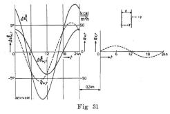
auftritt in bezug auf die Temperaturschwingung an der Maueraussenfläche, ebenfalls in Abhängigkeit von der Mauerdicke und der Temperaturleitfähigkeit, und beides für eine Tagesperiodizität.
