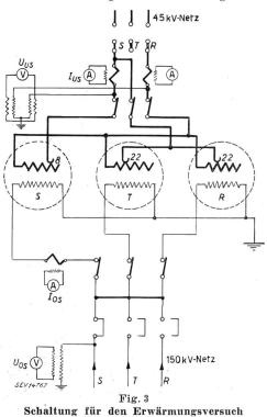
Volt- und Ampèremetern auf der 150- und 50-kV-Seite die Spannungen und Ströme gemessen. Fig. 4 und 5 zeigen Ausschnitte aus den Diagrammen der auf der 150-kV-Seite eingebauten registrierenden Volt- und Ampèremeter. Hieraus ist ersichtlich, wie während des Erwärmungsversuchs Spannung und Strom konstant gehalten werden konnten.
