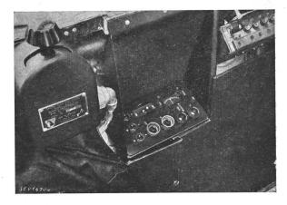
Fig. 2 Kommando- und Kontrollgerät des elektrischen Pilotapparates
