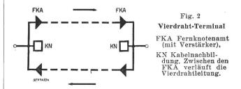
möglich: Tonfrequente metallische Vierdrahtleitungen leichter Pupinisierung oder Trägerleitungen nach dem Zwölf-, Vierundzwanzig- oder Koaxialsystem. Im Terminalverkehr wird ihre Restdämpfung auf 0,8...1,0 Neper eingestellt, im Durchgangsverkehr kann die Dämpfung auf 0...0,2 Neper reguliert werden. Zweidrahtleitungen sind nur noch für Sammelleitungen und für die Netzgruppen zu projektieren.
