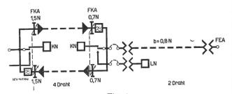
Fig. 4 Vierdraht-Zweidraht-Tandem ohne Wahlverstärker (Bezeichnungen wie in Legende Fig. 3)
