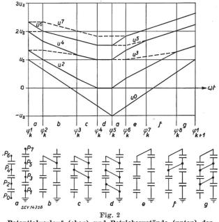
Potentialverlauf (oben) und Betriebszustände (unten) der sechsfachen Kaskadenschaltung während der k-ten Periode  $u^0$ ,  $u^2...u^7$  Potentiale an den Schaltpunkten  $P_0$ ,  $P_2...P_7$ . (Zureinfacheren zeichnerischen Darstellung wurde der Spannungsverlauf von  $u^0$  dreieck- statt sinusförmig angenommen);  $u_s$  Scheitelwert der Eingangswechselspannung; a...g Bezeichnung der 8 Betriebszustände;  $\hat{\varphi}_k^1$ ...  $\hat{\varphi}_{k+1}^1$  Umschaltphasen
