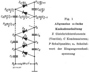
2) Eine 2m-fache Schaltung wird auch als m-stufig bezeichnet. In ihr wird die maximale Gleichspannung durch geradzahlige Vervielfachung erzeugt. Da aber allgemein jede Vervielfachung hergestellt werden kann, wird im folgenden stets nur von einer m-fachen Schaltung gesprochen.
