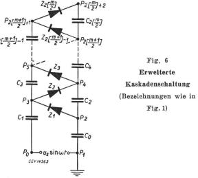
die erweiterte Kaskadenschaltung (Fig. 6). Die m-fache Schaltung baut sich somit aus m+1 Kondensatoren und m Gleichrichtern auf. Sie liefert für gerades m eine konstante Gleichspannung  $m u_s$ . Die Schaltpunkte der rechten Seite nehmen im stationären Zustand folgende Potentiale an:
