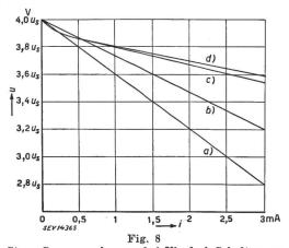
Strom-Spannungskurven bei Vierfach-Schaltungen u Klemmenspannung (Vielfaches des Scheitelwertes us der Eingangsspannung); i Belastungsstrom; a) erweiterte Kaskadenschaltung; b) Kaskadenschaltung; c) Pyramidenschaltung; d) erweiterte Pyramidenschaltung
