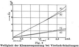
$\mathcal{E}_u$  Welligkeit in %; i Belastungsstrom; a) erweiterte Kaskadenschaltung; b) Kaskadenschaltung; c) Pyramidenschaltung; d) erweiterte Pyramidenschaltung
