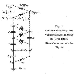
Die Spannungsdifferenz  $U_k^{\frac{n}{2}}$  zwischen dem dauernd geerdeten Punkt  $P_{-2}$  und einem beliebigen Schaltpunkt  $P_n$  ist gegeben durch
