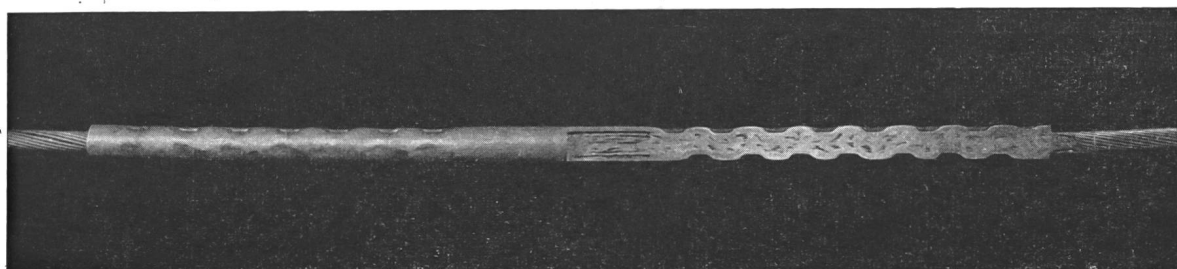
Fig. 18 Fertige Alutherm-Schweissschweißverbindung mit Rohrverbinder (teilweise aufgeschnitten)
