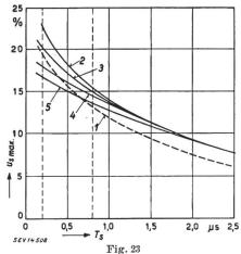
Maximalwerte der Spulenspannungen in einer Transformatorenwicklung
