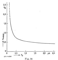
Maximalwerte der Windungsspannungen in einer Transformatorwicklung
