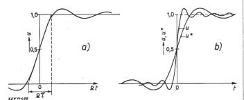
Fig. 13 Darstellung der Integralsinusfunktion  $u = \frac{U}{2} + \frac{U}{\pi} \int_{0}^{2\pi} \frac{\sin \omega t}{\omega} d\omega$
