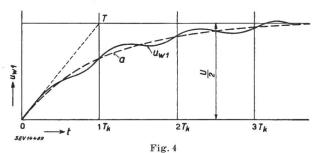
Zeitlicher Verlauf der Windungsspannung der ersten Windung (für den Fall  $T/T_k = 1$ )  $u_{w1}$  Windungsspannung; a Exponentialkurve des mittleren Spannungsanstiegs; U angelegte Stoßspannung; T Zeitkonstante;  $T_k$  Eigenschwingungsperiode; t Zeit.
