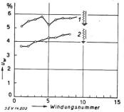
Fig. 17 Endwerte der Windungsspannungen an einer Polspule nach Ausklingen der Eigenschwingungen
