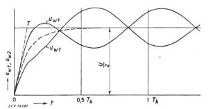
Fig. 6 Windungsspannung einer Zweiwindungsspule (T/T=0.1) Bezeichnungen wie in Fig. 4
