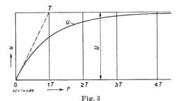
Stoßspannung mit exponentiellem Anstieg u Stoßspannung, gemessen zwischen Anfang und Ende der Wicklung; U Maximalspannung; T Zeitkonstante; t Zeit.
