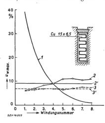
Fig. 18 Maximalwerte der Windungsspannungen an Eingangsspule eines Generators
