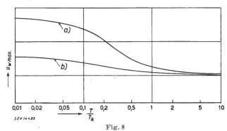
Maximalwerte der Windungsspannungen einer Zweiwindungsspule in Funktion des Wertes  $T/T_{\rm k}$
