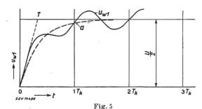
Zeitlicher Verlauf der Windungsspannung der ersten Windung (für den Fall  $T/T_k = \frac{1}{3}$ ) Bezeichnungen wie in Fig. 4
