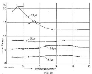
Maximalwerte der Windungsspannungen an den Eingangsspulen eines Generators
