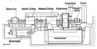
Fig. 1 Versuchsanlage der Oerlikon-Gasturbine Leistung: 1000 kW
