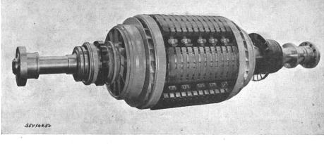
Fig. 6 Schnelläufer für Synchron-Grossgeneratoren
