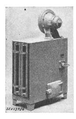
Description: Appareil, selon figure, pour aspirer la poussière provenant des machines à meuler et machines semblables. La soufflerie, entraînée par un moteur triphasé à induit en court-circuit, est montée sur le filtre à poussière. Le moteur, du type blindé, est muni de roulements à billes. L'appareil est muni d'une borne de terre.
