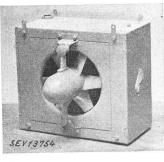
Description: Réchauffeur d'air, selon figure, comprenant des tubes à ailettes raccordés en service à une installation de chauffage central et un ventilateur de 295 mm de diamètre. Celui-ci est entraîné par un moteur monophasé blindé, à induit en court-circuit, démarrant automatiquement. Dimensions du bâti en tôle:  $290 \times 500 \times 560$  mm. Les bornes sont fixées dans un coffret vissé, prévu pour le
