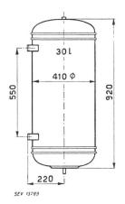
Description: Chauffe-eau à accumulation pour montage mural, selon croquis, comprenant un corps de chauffe et un régulateur de température avec dispositif de sûreté.
