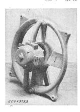
Description: Ventilateur, selon figure, entraîné par un moteur triphasé à induit en courtcircuit, blindé, muni de bornes permettant le couplage en étoile ou en triangle. Diamètre de l'hélice: 490 mm. La boîte à bornes, vissée, est prévue pour le raccordement de tubes acier. Le moteur est muni d'une borne de terre.
