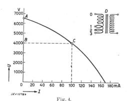
Strom-Spannungs-Charakteristik eines Streufeldtransformators zur Speisung von Hochspannungs-Fluoreszenzröhren
