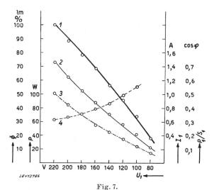
Charakteristiken einer Hochspannungs-Fluoreszenzröhre
