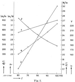
Charakteristiken einer Hochspannungs-Fluoreszenzröhre (Spirale) von 5 m abgewickelter Länge; Streufeldtransformator  $220/2500~\rm{V}$
