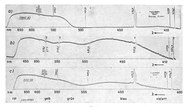
Fig. 3. Spektrographische Aufnahme der von drei verschiedenen Hochspannungs-Fluoreszenzröhren ausgestrahlten Wellenlängen
