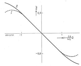
Fig. 7. Diskriminator-Kennlinien  $u_{NF}=\mathbf{f}\left(x\right)$  für den Fall  $Q_1=Q_2=Q$
