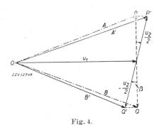
Vektorielle Darstellung der Spannungsverhältnisse beim Phasensprung-Diskriminator
