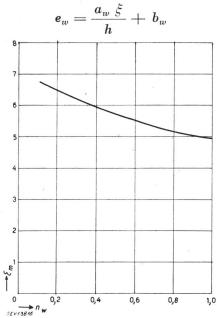
Fig. 6. Mittlere Leistungsziffern  $\epsilon_m$  in Abhängigkeit der Leistungsaufteilung  $n_w$
