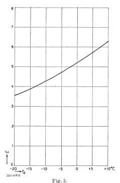
Leistungsziffern ε in Abhängigkeit der Aussentemperaturen ta (auf Grund von Fig. 4)
