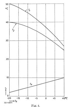
Heizwassertemperaturen t in Abhängigkeit der Aussentemperaturen  $t_a$  für eine Deckenheizung
