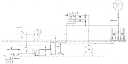
Fig. 12. Schema der Wärmepumpenheizung bei Escher Wyss
