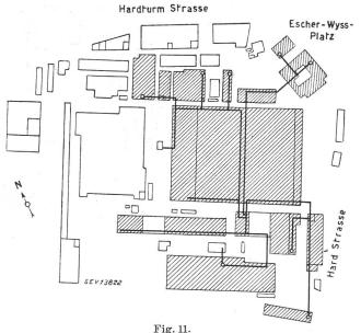
Lageplan nach der Vereinheitlichung des Heizsystems Die schraffierten Gebäude werden aus der neuen Wärmezentrale mit Grundwasser-Wärmepumpe gespeist
