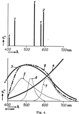
Relative spektrale Strahlungsleistung  $P_{\lambda}$  gebräuchlicher Lichtquellen
