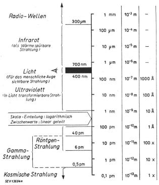
Fig. 1. Die elektromagnetischen Wellenstrahlen und ihre Wellenlängen 1  $\mu m = 10^{-6} \ m \ (= 1 \ \mu)$
