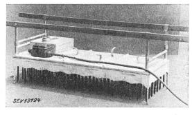
Description: Appareil à stériliser la terre, selon figure, comprenant 126 tiges chauffantes fixées à la partie inférieure d'un bâti en tôle de fer zinguée. Un corps de chauffe est logé dans chacune des tiges; les résistances sont connectées en groupes couplés pour l'alimentation en courant triphasé. A la partie supérieure du bâti se trouvent un interrupteur et
