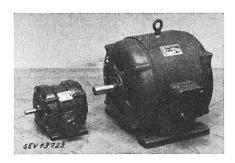
Description: Moteurs triphasés, ventilés, à induit en courtcircuit, selon figure, munis de paliers à billes; construction ouverte. Les six extrémités de l'enroulement statorique, en fil de cuivre, sont connectées à une plaque à bornes placée sur le côté du bâti et protégée par un couvercle vissé (couplage en étoile ou en triangle). Chaque moteur possède une borne de terre.
