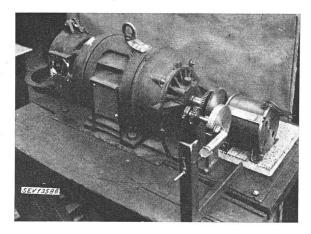
Fig. 8. Versuchsanordnung des Dreiphasen-Induktionsreglers
