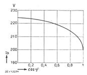
Fig. 4. Abhängigkeit der Netzspannung vom cos  $\varphi$  des Belastungsstromes
