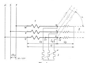
Fig. 1. Schema des Dreiphasen-Induktionsreglers als Compound-Transformator
