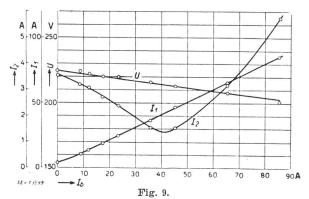
Charakteristiken des Dreiphasen-Induktionsreglers mit zusätzlichem Feder-Drehmoment
