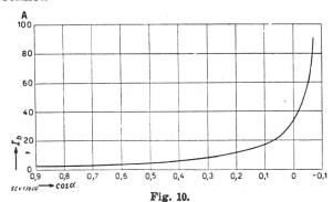
Abhängigkeit des Verdrehungswinkels  $\alpha$  des freigelassenen Läufers vom Belastungsstrom  $I_b$  (berechnete Werte nach Gleichung (15))  $U_2=200~{
