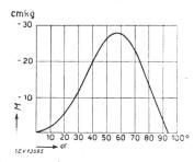
Fig. 5. Erforderliches zusätzliches Drehmoment M in Funktion der Läuferstellung  $\alpha$  zur Erreichung einer linearen Regelcharakteristik
