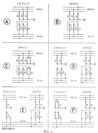
Kombination verschiedener Schaltungen von Einphasen-Transformatoren 220/60 kV
