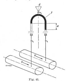
Mesure de faibles différences de pression Tube en U renversé rempli d'un liquide de densité  $\gamma < E$  Entonnoir de remplissage. T Toluol ( $\gamma = 0.687$ )
