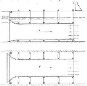
Fig. 12. Tuyère provisoire en bois, de section carrée ou rectangulaire
