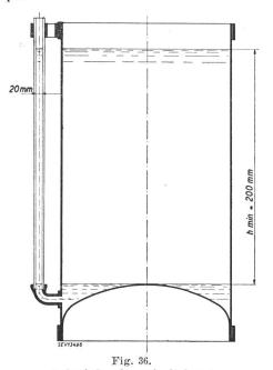
Relevé du réservoir étalonné Forme normale d'un réservoir de mesure transportable et disposition du tube piézométrique
