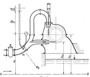
Fig. 9. Turbine à action A deux injecteurs. Arbre horizontal. Chute nette  $H=z_e-\frac{z_{a_1}+z_{a_2}}{2}+\frac{p_e}{\gamma}+\frac{v_e^2}{2g}$
