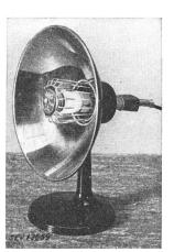
Description: Radiateur à feu vif, selon figure, avec réflec-teur en tôle de 270 mm de diamètre. Le fil résistant est bobiné sur une pièce cylindrique en matière céramique; le corps de chauffe est protégé contre les contacts fortuits. Le radiateur est muni d'un pied en matière isolante moulée, l'inclinaison est réglable. Le raccordement du cordon d'alimentation s'effectue par une fiche d'appareil.
