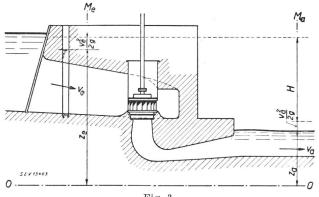
Fig. 3. Turbine à réaction
