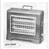
Description: Radiateur à feu vif, selon figure, comprenant deux corps chauffe superposés, composés de fil résistant enroulé en boudin et bobiné sur des pièces en matière céramique. Un réflecteur en tôle est placé derrière chacun des corps de chauffe. Un interrupteur est inséré dans le circuit du corps de chauffe supérieur. Le déclenchement total du radiateur s'effectue
