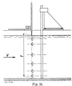
Mesure de la hauteur d'eau dans la section de jaugeage à l'aide d'un limnimètre à pointe
