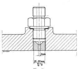
Fig. 41. Mesure de la pression
