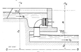
Fig. 1. Turbine à réaction (Francis, à hélice, Kaplan) Chambre d'eau ouverte. Arbre horizontal. Tube d'aspiration en tôle.
