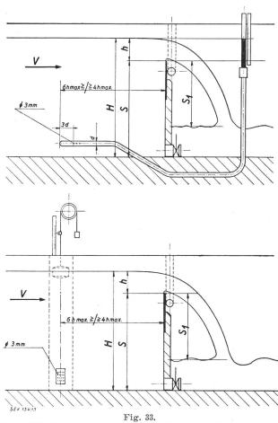
Dispositifs de mesure de la charge h sur l'arête déversante en haut: piézomètre avec tubulure horizontale de mesure de
