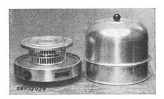
Description: Four selon figure. Le corps de chauffe, monté dans la partie inférieure, se compose de fil résistant enroulé en boudin et bobiné sur une pièce en matière céramique, de forme cônique. Une plaque en tôle de fer ajourée, placée audessus du corps de chauffe, sert de protection contre les contacts fortuits. Le four est muni d'un interrupteur de réglage et d'une fiche d'appareil encastrés. L'anneau intermédiaire et le couvercle sont en tôle d'aluminium.
