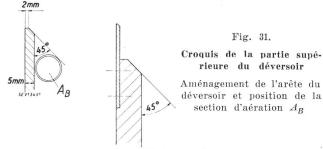
La section des orifices d'aération de la nappe devra être d'au moins  $\frac{1}{2}$  % du produit  $B \cdot s_1$  (fig. 29 et 31).
