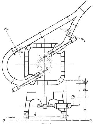
Fig. 10. Turbine à action A deux injecteurs. Arbre vertical. Chute nette  $H=z_e-z_a+\frac{Q_1\left[\frac{p_{e_1}}{\gamma}+\frac{v_{e_1}^2}{2g}\right]+Q_2\left[\frac{p_{e_2}}{\gamma}+\frac{v_{e_2}^2}{2g}\right]}{Q_1+Q_2}$
