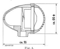
Gehäuse des Kommandomikrophons mit eingebautem auswechselbarem System
