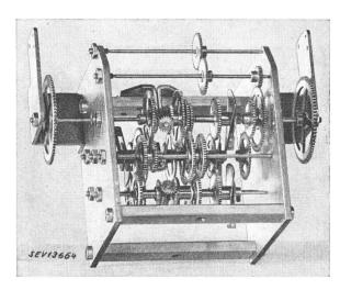
Fig. 4. Mechanismus zur Messung des Scheinverbrauchs
