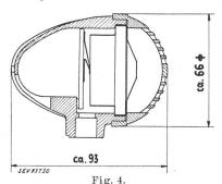
Gehäuse des Kommandomikrophons mit eingebautem auswechselbarem System
