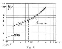
Frequenzgang der Eigenimpedanz  $|\mathfrak{F}_1|$  des Kommandomikrophons mit Streubereich Gleichstromwiderstand  $r_0 = \mathrm{ca.\,100}$   $\Omega$
