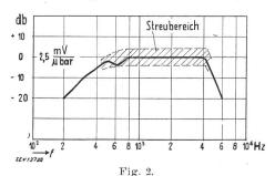
Frequenzgang der Ausgangsspannung (EMK) des Kommandomikrophons mit Streubereich Spannungsempfindlichkeit 2,5  $\frac{mV}{m}$
