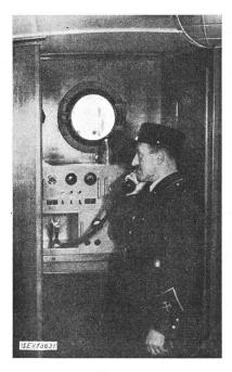
Fig. 11. **FM-Funkstation**in einem Löschboot der Basler Feuerwehr
