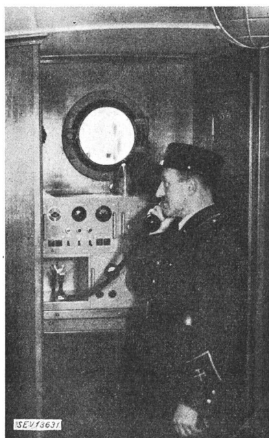
Fig. 11. FM-Funkstation in einem Löschboot der Basler Feuerwehr
