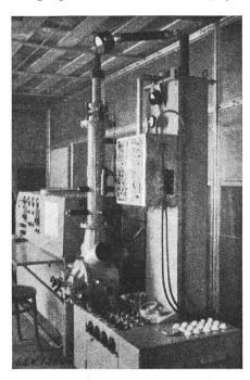
Fig. 6. Intérieur de la cage de Faraday, en 1944 avec un oscillographe cathodique avec sas pour film, source de tension cathodique à 50 kV et relais de balayage universel
