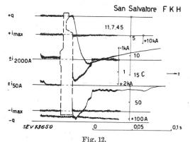
Oscillogramme d'un courant de foudre avec une décharge partielle négative et une décharge positive
