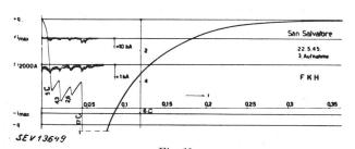
Oscillogramme d'un courant de foudre de grandeur et durée moyenne
