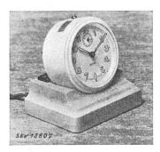
Description: Réveil avec socle en bois dans lequel sont montés deux interrupteurs à bascule unipolaires et une prise de courant bipolaire mobile, pour le raccordement de l'appareil à enclencher ou déclencher. L'un des interrupteurs est enclenché par la clef de remontage de la sonnerie, lorsque celle-ci fonctionne. Le deuxième interrupteur est déclenché par un levier
