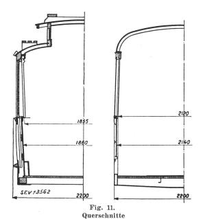
von Strassenbahnwagen alter und neuer Konstruktion Beim neuen Wagentyp (rechts) wird der verfügbare Raum rationell ausgenützt
