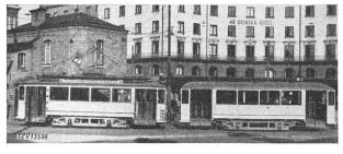
Fig. 6. Strassenbahnzug alter Typ für Innenstadtverkehr Der Motorwagen wurde durch Umbau (1926) verbessert. Der Anhängewagen gehört einer Fabrikationsserie aus dem Jahre 1929 an.
