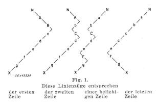
Schreibt man die verschiedenen Stromzweige des gewählten Beispieles auf diese Weise an, wobei man wieder mit Rücksicht auf möglichst kurze Verbindungsleitungen die benachbarten Schaltelemente aufeinander folgen lässt (Berücksichtigung der räumlichen Anordnung der Schaltelemente), so ergeben sich die Linienzüge nach Fig. 1.
