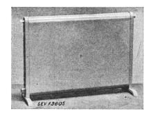
Description: Radiateur selon figure. Le corps de chauffe est constitué par une masse conductrice appliquée sur l'une des faces d'une plaque d'éternite de 20 mm d'épaisseur; celle-ci est montée dans un bâti en aluminium dont elle est isolée. Le raccordement au réseau s'effectue par une fiche d'appareil fixée au radiateur. Les poignées sont en matière isolante.
