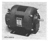
Description: Moteur monophasé à induit en courtcircuit, ventilé, selon figure; type ouvert. Le démarrage s'effectue par un enroulement auxiliaire qui est déclenché automatiquement par un interrupteur centrifuge. Les paliers sont à coussinets, les bornes de raccordement et de terre sont protégées par un couvercle vissé. Le moteur est
