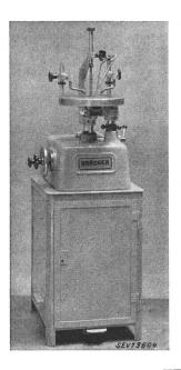
Description: Machine à limer et à scier, selon figure, entraînée par un moteur triphasé à induit en court-circuit, monté dans le socle. La course et la vitesse sont réglables. La machine est munie d'un petit ventilateur pour éloigner les copeaux, d'un interrupteur à pied et d'un socle de coupe-circuit tripolaire. Le raccordement au réseau est prévu par une ligne fixe.
