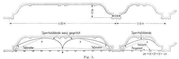
Schnitt A—B durch 2 Deckenfelder Oben vor dem Umbau; unten nach dem Umbau
