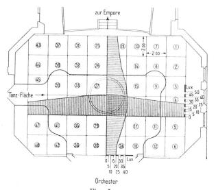
Fig. 5. Beleuchtungsstärken in den beiden Hauptachsen
