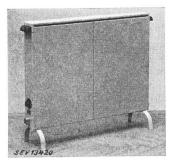
Description: Radiateur selon figure. Le fil résistant enroulé en boudin est fixé à deux plaques d'éternite superposées, montées dans la partie inférieure d'un boîtier ventilé, en tôle d'aluminium. Les plaques d'éternite sont isolées du bâti. Un interrupteur de réglage encastré est monté sur l'un des côtés du radiateur. Le raccordement du cordon d'alimentation s'ef-
