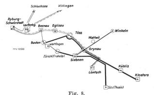
Bestehendes HF-Verbindungsnetz der Zone NOK-EWZ (Sprech- und Messverbindungen nach dem Zweiseitenband-System)
