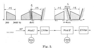
Schematische Darstellung der Einseitenband-Modulation f. Bandbreite des Telephongespräches (Niederfrequenz Trägerfrequenz von 8 kHz, erzeugt im ersten Träge enerator rägerfrequenz von n.4 kHz, erzeugt im zweiten
