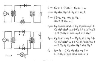
Fig. 5. Prinzip der Einfach- und Gegentaktmodulation  $U_1$  Modulationsspannung (Niederfrequenz)  $U_0$  Spannung des Trägergenerators (Hochfrequenz)
