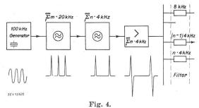
Blockschema eines Trägergenerators
