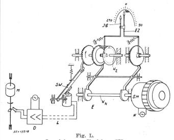
Impulsfrequenz-Verfahren III (Durch ein Zeitwerk rückstellbares mechanisches Integriergetriebe)
