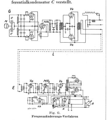
Bei einer Messwertänderung steigt dann die Frequenz im Oszillator  $O_1$  um einen gewissen Frequenzhub, während die Frequenz im Oszillator  $O_2$  um denselben Hub sinkt. Beide Signalströme werden nun in einer Mischstufe (MR1)1 zu einem Signalstrom mit der Mischfrequenz 1 verwandelt. Dieser geht dann über ein Bandfilter, Gegentaktverstärker Ve, Fernwirkkanal L
