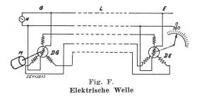
des Gebers mit der des Empfängers übereinstimmt, da dann die EMKe in den Statorwicklungen von DG und DE praktisch gleich gross werden. Der Ausgleichstrom verursacht das Einstelldrehmoment für die Gleichstellung.
