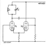
Oszillatorschaltung mit zwei Röhren in Kathodenkopplung;
