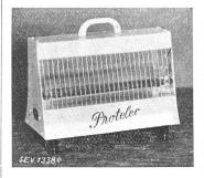
Description: Radiateur à feu vif selon figure. Le fil résistant, enroulé en boudin, est bobiné sur une barre en matière céramique; celle-ci est disposée devant un réflecteur en tôle et est protégée par un grillage contre les contacts fortuits. Le bâti est en tôle d'aluminium, les poignées en matière isolante. Le raccordement du cordon d'alimentation s'effectue par une fiche d'appareil.
