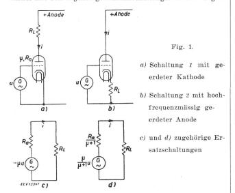
widergegeben.  $\mu$  bedeutet dabei den Verstärkungsfaktor und  $R_{\star}$  den inneren Widerstand der Röhre, während  $R_{\mathsf{L}}$  den Belastungswiderstand darstellt.
