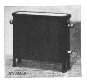
Description: Radiateur selon figure. Le fil résistant, enroulé en boudin, est fixé à une plaque d'éternite montée dans un bâti en tôle de fer, dont elle est isolée par des pièces en matière céramique. La partie supérieure et inférieure du hâti sont fermées par du treillis. Un interrupteur à bascule permet de faire fonctionner le radiateur à pleine ou demi charge. Le raccordement du cordon
