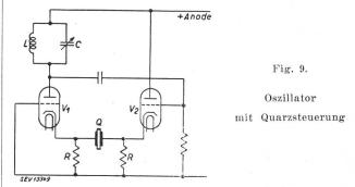
Oszillator wie im Falle von Fig. 7. Ausserhalb der Resonanz wird der Widerstand des Quarzes sehr gross im Vergleich zu R. Die erregende Spannung wird deshalb sehr klein und ändert ihre Phase, so dass die Schwingungen abreissen.
