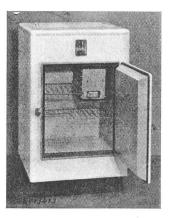
Description: Armoire frigorifique de ménage selon figure. Le froid est produit par un dispositif à absorption à fonctionnement périodique, monté à l'arrière de l'armoire; refroidissement à air. Commande par deux régulateurs de température logés dans le bouilleur et par un contacteur monté sous l'armoire. Un tiroir à glace est placé dans l'évaporateur. Raccordement au réseau par un cordon à trois conducteurs muni d'une fiche 2 P + T.
