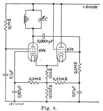
Aus dem Prinzipschema von Fig. 7 abgeleitete praktische Schaltung mit Penthoden
