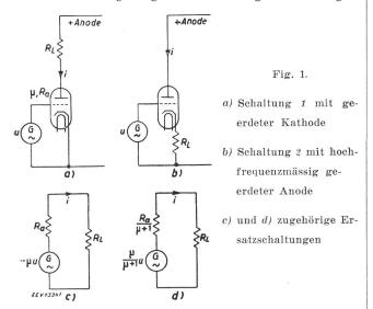
widergegeben.  $\mu$  bedeutet dabei den Verstärkungsfaktor und  $R_a$  den inneren Widerstand der Röhre, während  $R_{\rm L}$  den Belastungswiderstand darstellt.
