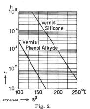
«Vieillissement» t d'un vernis organiue et d'un vernis silicone, appliqués sur un fil de cuivre, en fonction de la température θ (on a mesuré le temps qu'il fallait pour que le vernis montre des fentes après un allongement du fil de 3 %)
