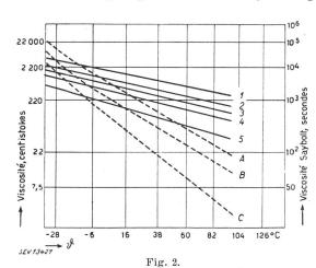
Variation de la viscosité de fluides Silicones (1-5) et d'huiles minérales (A-C), en fonction de la température
