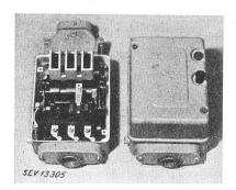
thermiques et les boutons-poussoirs sont en matière isolante moulée. Les boîtes pare-étincelles sont en matière céramique. Les déclencheurs peuvent être réglés au moyen d'un tournevis. Le boîtier est en tôle d'acier et est muni d'une borne de terre à l'intérieur et à l'extérieur. Déclencheurs pour 0,25 à 0,45 A, 0,4 à 0,7 A, 0,6 à 1,1 A, 1 à 1,8 A, 1,6 à 2,8 A, 2,5 à 4,5 A, 4 à 7 A, 6 à 11 A et 10 à 15 A.
