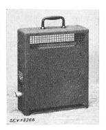
Description: Radiateur selon figure. Le fil résistant, enroulé en boudin, est fixé à la face extérieure de deux plaques d'éternite juxtaposées et montées dans un bâti en tôle de fer dont elles sont isolées. La partie inférieure du bâti est fermée par du treillis. Le radiateur est muni d'un interrupteur de réglage à bascule encastré, d'une fiche d'appareil pour le raccordement du cord'alimentation et don poignées en matière isolante.
