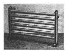
Description: Radiateur en métal léger, selon figure. Le fil résistant enroulé en boudin est logé dans des tubes fixés à deux montants; isolation au mica. Les pieds et les poignées sont en bois. L'interrupteur de réglage et la fiche d'appareil sont encastrés.
