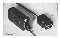
petite lampe, un interrupteur et une fiche d'appareil. Le transformateur, à enroulements séparés, est logé dans un boîtier en matière isolante moulée muni de deux tiges, formant une fiche qui peut être introduite dans une prise bipolaire normale 6 A 250 V, pour alimenter le transformateur. L'enroulement primaire est commutable pour 110 à 125 V et 220 V. La lampe de poche est reliée au transformateur par un cordon à isolation thermoplastique muni d'une prise d'appareil.
