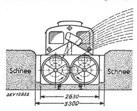
Fig. 1. Elektrische Schneeschleudermaschine der Brünigbahn Spurweite 1 m
