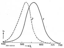
Fig. 2. Courbes  $V_{\lambda}$  donnant la valeur du facteur de visibilité relative en fonction de la longueur d'onde
