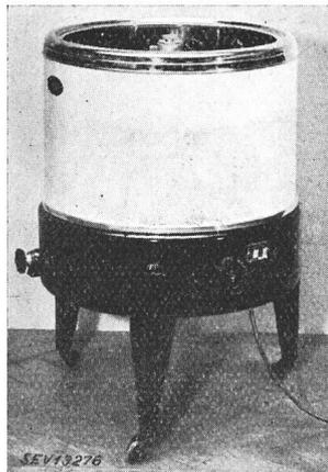
**Description:** Machine à laver mobile, selon figure, avec chauffage électrique. Entraînement par un moteur triphasé à induit en court-circuit, blindé, muni d'un réducteur de vitesse. Les corps de chauffe sont disposés à l'intérieur de la cuve. Le dispositif de lavage décrit des mouvements rotatifs alternés. L'interrupteur du chauffage (à deux positions) et celui du moteur sont encastrés. Le cordon d'alimentation 3 P+T est fixé à demeure.
