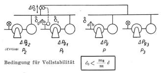
$m_0 = \frac{P_1}{P_1 + P_2} =$ Anteil der nicht blockierten Maschinen im leistungsgeregelten Netz  $\frac{P}{P+P_3}= ext{Anteil der nicht blockierten Maschinen im drehzahlgeregelten Netz}$
