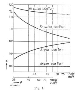
Coefficient d'efficacité des lampes à incandescence  $\eta$  en fonction de la puissance P
