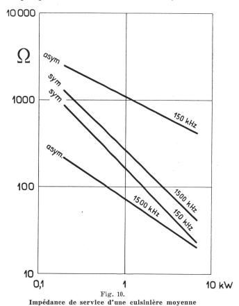
La fig. 10 montre l'allure de l'impédance en fonction de la puissance de service correspondante; elle représente les valeurs statistiques de ses composantes symétriques et asymétriques par rapport au châssis, mesurées aux bornes de la cuisinière.
