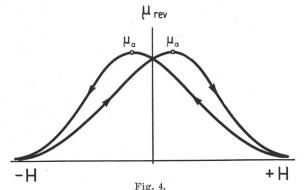
Cycle d'hystérésis de la perméabilité réversible (courbe limite)
