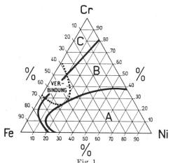
Fig. 1. Répartition des phases pour le système ternaire chrome-nickelfer à la température ambiante Verbindung = combinaison
