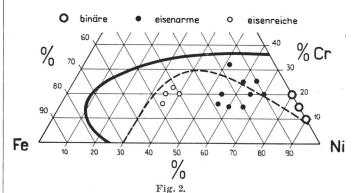
Vue d'ensemble des alliages chrome-nickel pour hautes températures eisenarme = alliages pauvres en fer eisenreiche = alliages riches en fer
