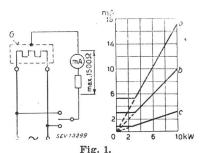
Messanordnung zur Ermittlung des Ableitstromes nach VDE 0720/IX. 40, § 22/c
