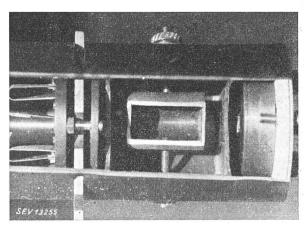
Fig. 1a. Versuchsrohr (Generator für  $\lambda = 9$  cm)
