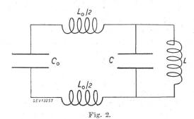
Allgemeines Schema eines Ausgangskreises in einem Verstärker mit normalen Verstärkerröhren
