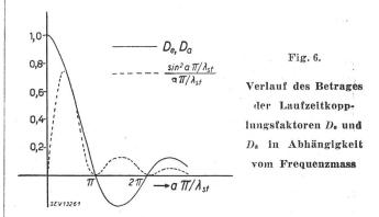
auch in den Elektroden ein sinusförmiger Wechselstrom fliesst, dessen Frequenzgang in Fig. 6 dargestellt ist, und der durch die Beziehung  $\frac{\sin a \ \pi/\lambda_{st}}{a \ \pi/\lambda_{st}}$ gegeben ist. Dieser Frequenzgang ist zugleich der gesuchte Laufzeitkopplungsfaktor.
