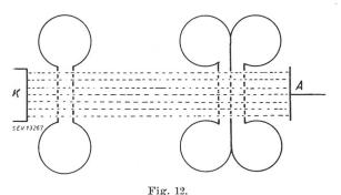
Laufzeitgerät nach Art des Klystrons mit zweifacher Auskoppung
