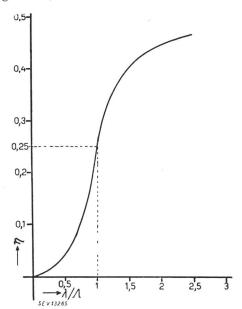
Fig. 10. Wirkungsgrad eines voll ausgesteuerten Verstärkers in Funktion der relativen Wellenlänge
