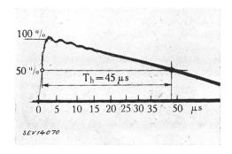
Fig. 3 Kathodenstrahl-Oszillogramm der Stoßspannung beim Versuch am 24-kVA-Transformator Rückenverlauf der Stosswelle
