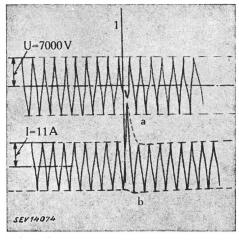
Fig. 8 Schleifen-Oszillogramm beim Stossversuch am 2000-kVA-Transformator
