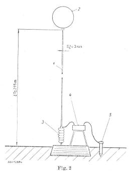
Messanordnung mit Ballonantenne
