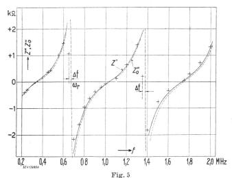
Imaginärteil der Strahlungsimpedanz in Funktion der Frequenz
