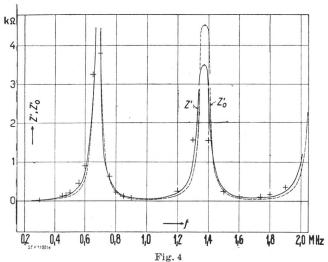
Realteil der Strahlungsimpedanz in Funktion der Frequenz Z' Realteil der Strahlungsimpedanz (Antennenverluste berücksichtigt). Zo' Realteil der Strahlungsimpedanz (Antennenverluste vernachlässigt). f Frequenz.
