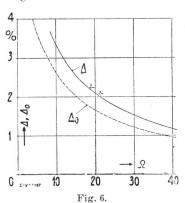
Antennenverkürzung in Funktion der Grösse  $\mathcal Q$   $\mathcal A$  Antennenverkürzung (Antennenverluste berücksichtig).  $\mathcal A_0$  Antennenverkürzung (Antennenverluste vernachlässigt).  $\mathcal Q=2$  in  $\frac{2l}{e}$  (l Länge der Antenne, 2e Drahtdurchmesser).
