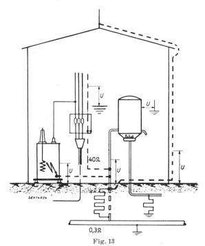
Unterbrechung einwandfreier Erdungen infolge Einbaus isolierender Schraubmuffen
