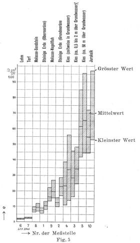
Die spezifischen Widerstände verschiedener Bodenarten Ermittelt während zwei Jahren an zwei Erdungen in einer Tiefe von 1...1,5 m unter der Erdoberfläche (siehe Sprecher, E.: Untersuchung über den Erdungswiderstand verschiedener Bodenarten und die Vorausberechnung der Elektroden. Bull. SEV Bd. 25(1934), Nr. 15, S. 397...404).
