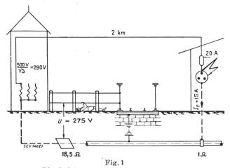
Die Gefahren hoher Erdungswiderstände Erzeugung eines gefährlichen Spannungstrichters im Erd-boden; Berührungsspannung 275 V infolge zu hohen Wider-standes der Transformatornullpunkt-Erdung
