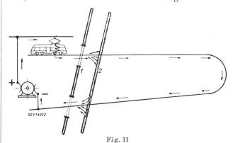
Wirksame Isolierung einer Wasserleitung gegen Korrosionsangriffe durch Einfügen eines genügend langen Rohrstückes aus Eternit
