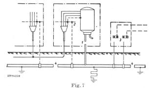
Parallelschaltung von Nulleiter, Telephonerdung oder Gasleitung mit der Wasserleitung
