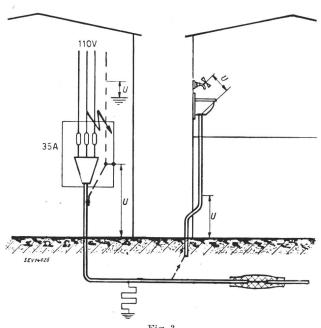
Fig. 3 Die Gefahren bei Verwendung der Starkstromkabel-Bleimäntel als Erdelektrode
