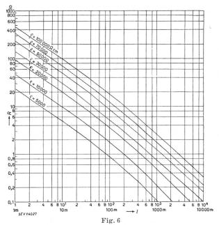
Erdübergangswiderstände R blanker Rohrleitungen in Abhängigkeit von der Elektrodenlänge l bei verschiedene spezifischen Erdübergangswiderständen e des Erdbodens Berechnung der Kurven:
