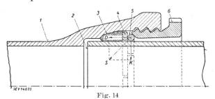
Elektrisch überbrückte Schraubmuffe
