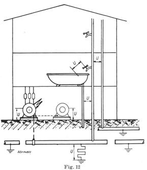
Uebertragung gefährlicher Berührungsspannungen auf Schutzerdung und Hauswasserinstallation infolge Einbaus isolierender Schraubmuffen
