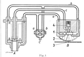
Schéma de fonctionnement de l'appareil pneumatique de signalisation à distance
